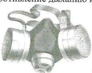
Респиратор РУ-60М состоит из резиновой полумаски, двух сменных фильтрующих патронов, содержащих специализированный поглотитель, пластмассовых манжет с клапаном вдоха, клапанами выдоха с предохранительным экраном, оголовья. Сменные фильтрующие патроны поставляются в комплекте респиратора, но могут поставляться и отдельно. Предназначен для защиты органов дыхания человека одновременно от паро и газообразных вредных веществ и аэрозолей.
